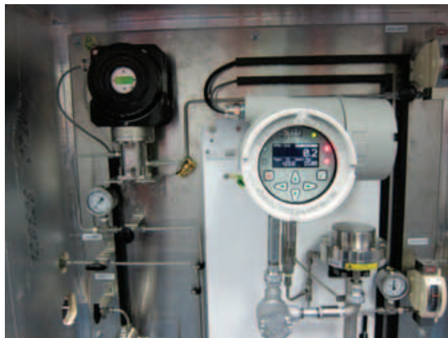
Рис. 3. Преобразователь «КОНГ-Прима-2М» в составе с анализатором влажности «Auroga» фирмы «GE Sensing EMEA»
